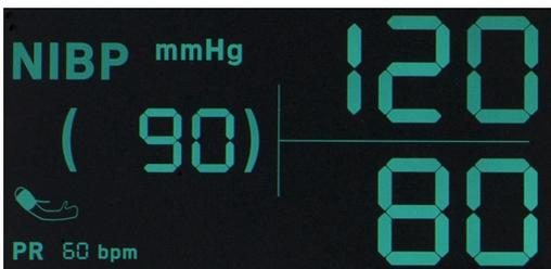
Die Pulsfrequenz wird unter der NiBP-Messung angezeigt.
