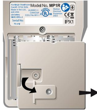
1. Lösen Sie die Sicherungsschraube und nehmen Sie den Batteriefachdeckel ab.
